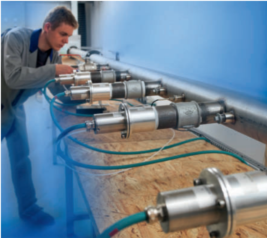
Im Windkanal werden die neu entwickelten Sensoren auf ihre maximale Belastbarkeit hin genauestens untersucht
